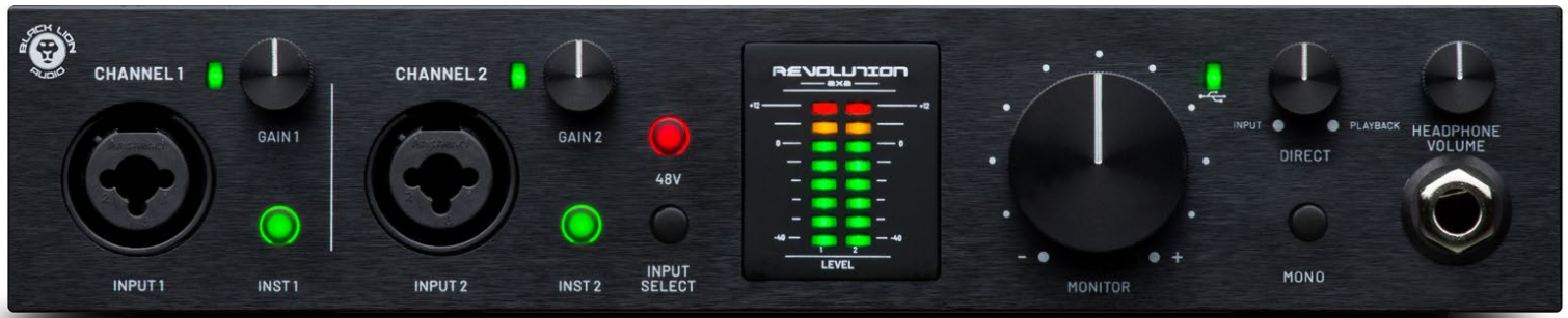
Frontseitig findet man zwei Kombibuchsen (XLR/TRS), die Pegelanzeige, Kopfhörerbuchse sowie sämtliche Potis und Schalter.
