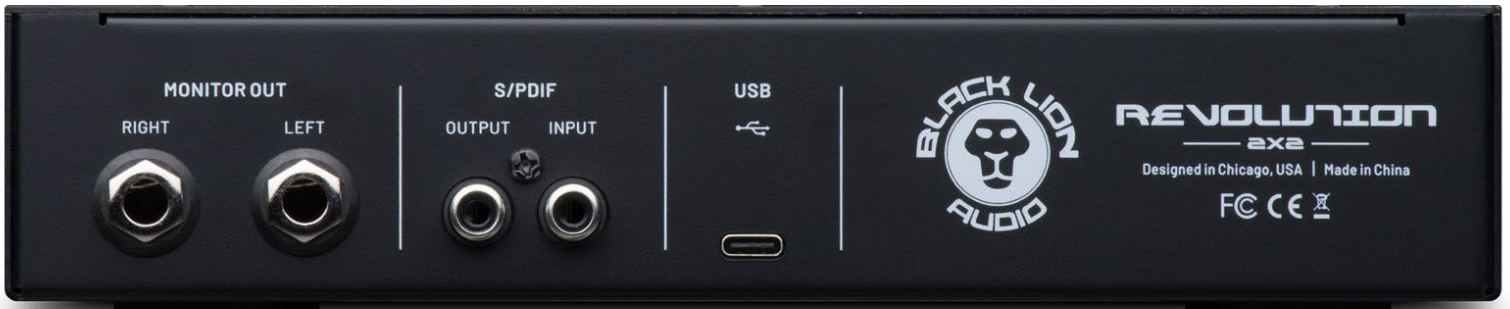
Anschluss von Monitorboxen, digitalen Quellen und die Verbindung mit dem Computer erfolgen rückseitig.
